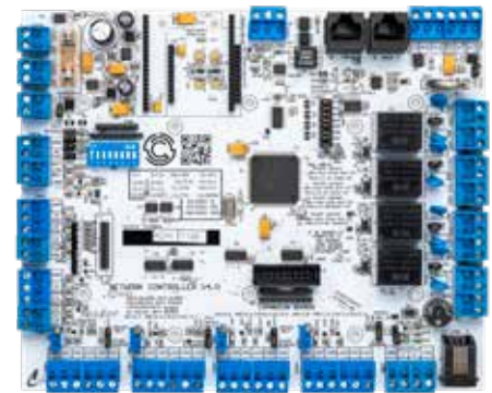
Network 4 Door Controller CSEVO4
